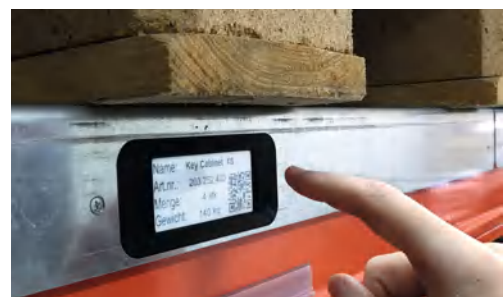
Signalisation ESL sur chaque emplacement de palette
